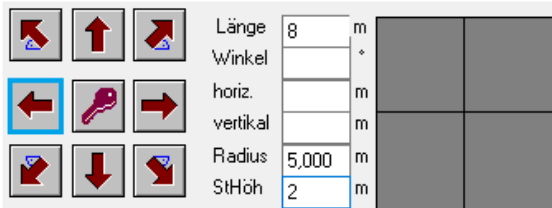
Bild 2.5) Stichbogen mit L = 8 m und Stichhöhe = 2 m
