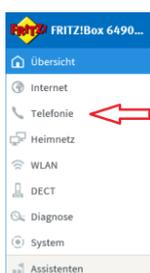
Anschließend wählen Sie „Telefoniegeräte“ -> „neues Gerät einrichten“:
