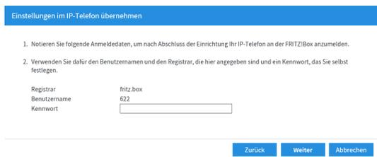
Der Registrar ist Ihre FritzBox. Dort sind alle Verbindungen registriert. Der Benutzername entspricht der internen Direktwahlnummer und mit dem Kennwort stellen sie sicher, dass Ihre Verbindung nur von IP-Telefonen genutzt werden kann, an denen das Kennwort hinterlegt ist.
