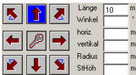
Bild 4.2) Gerade mit L = 10 m senkrecht nach oben
