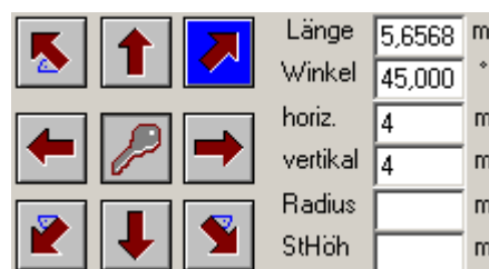
Bild 2.4) Schräge mit horizontaler und vertikaler Länge = 4 m nach rechts oben
