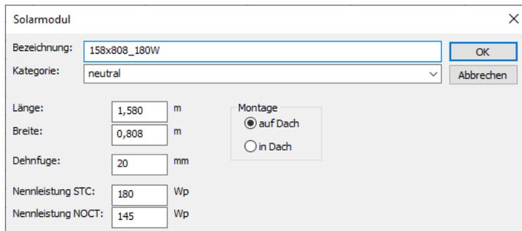
Bild: Eingabedialog Solarmodule
