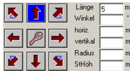
Bild 2.3) Gerade mit L = 5 m senkrecht nach oben
