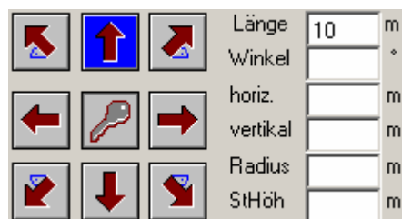
Bild 4.2) Gerade mit L = 10 m senkrecht nach oben
