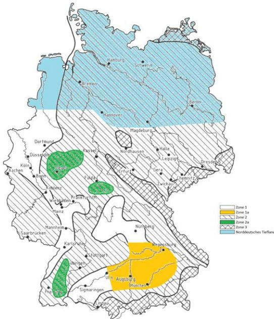
Bild 2: Schneelastzonenkarte für Deutschland (Quelle: DIN EN 1991-1-3/NA:2010-12)
