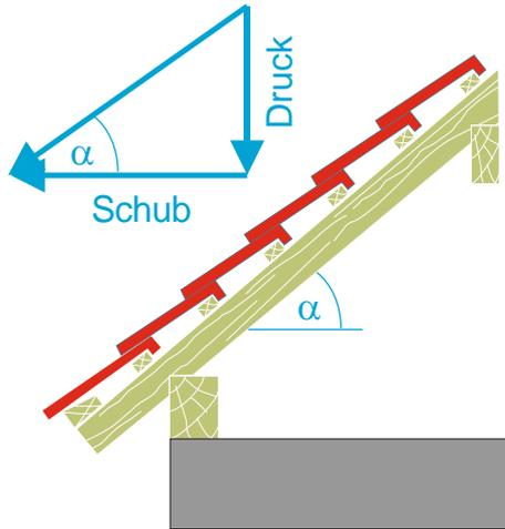
Bild 6: Wirkrichtung der Trauflast
