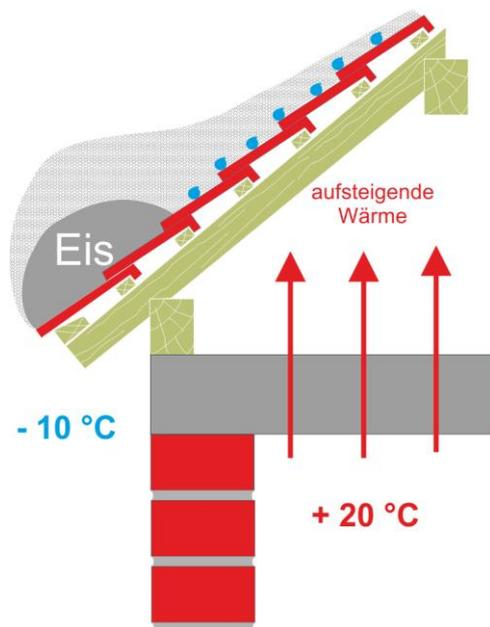
*Beheizte Gebäude erwärmen den Schnee von unten und bringen dessen Unterseite zum Schmelzen. Das Schmelzwasser rinnt unter der Schneedecke zur Traufe und gefriert im Bereich des unbeheizten Traufüberstandes zu einer Eisschanze.*
